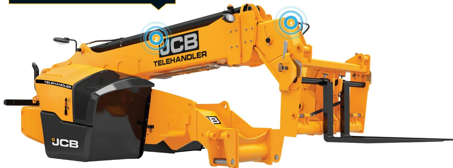
Cilindros de elevación y desplazamiento centralizados aseguran que las tensiones de carga sean distribuidas de manera uniforme.
