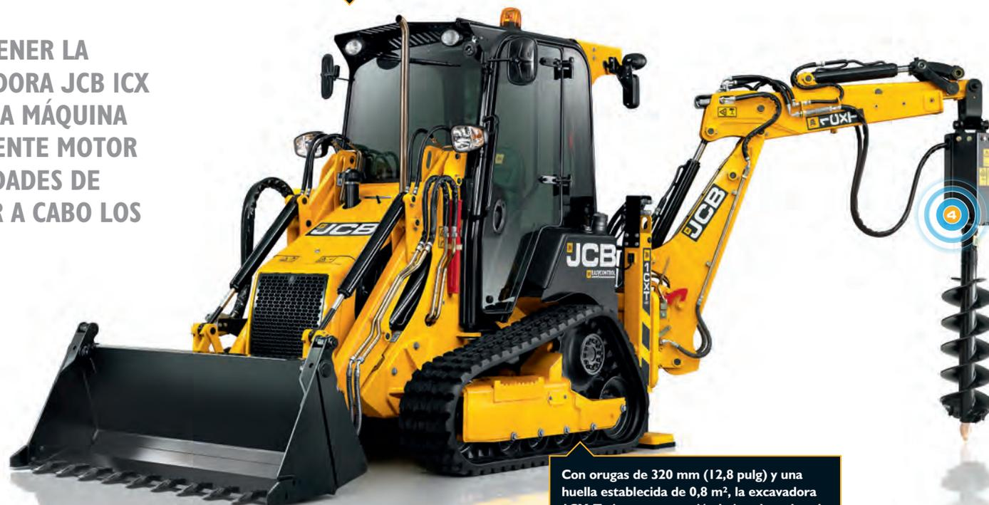
Con orugas de 320 mm (12,8 pulg) y una huella establecida de 0,8 m<sup>2</sup>, la excavadora ICX-T ejerce una presión baja sobre el suelo para causar menos daño a la superficie.
