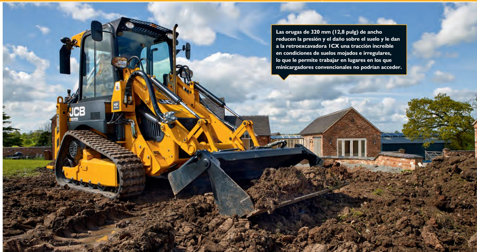
Las orugas de 320 mm (12,8 pulg) de ancho reducen la presión y el daño sobre el suelo y le dan a la retroexcavadora ICX una tracción increíble en condiciones de suelos mojados e irregulares, lo que le permite trabajar en lugares en los que minicargadores convencionales no podrían acceder.
